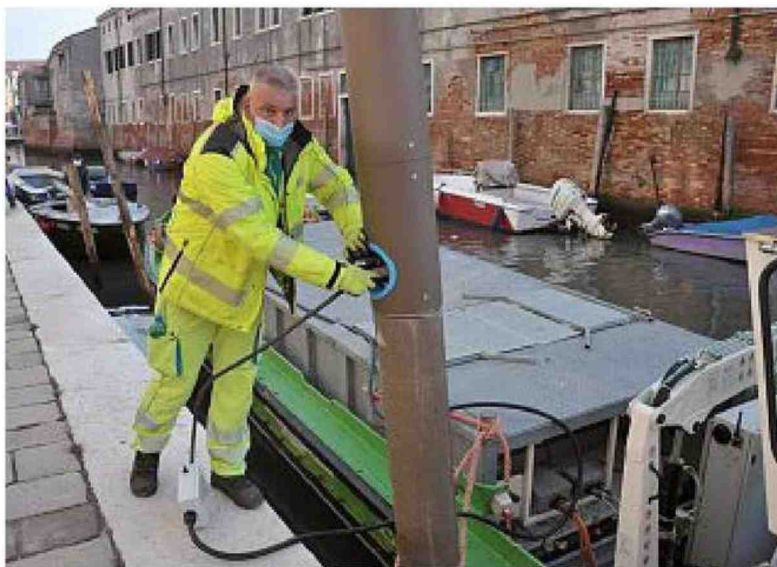
E-dock Il prototipo alla Misericordia. Oggi sono un centinaio le barche che possono usarlo ( Vision )
